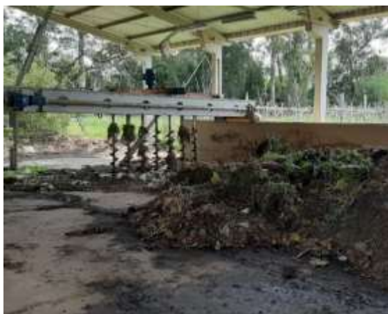
Figura 10 – À esquerda, pás de forma helicoidal utilizadas para revolver o resíduo na Unidade de Compostagem da UFSM, à direita, a Usina de Compostagem da UFSM.
